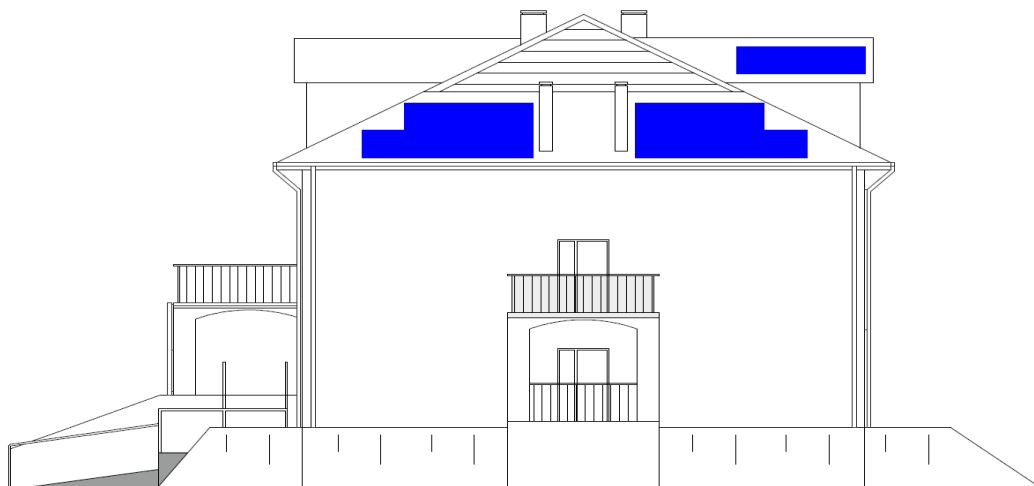
Rysunek 3. Rozmieszczenie modułów na dachu budynku.
