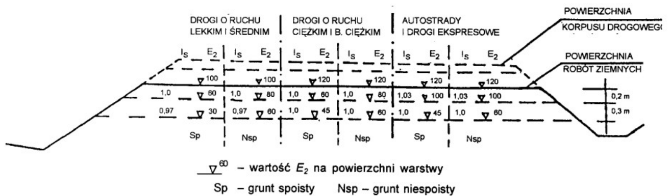
Rys. nr 1. Wartości wymagane w podłożu wykopów wskaźnik zagęszczenia I_s i wtórnego modułu odkształcenia E_2 , megapaskali
